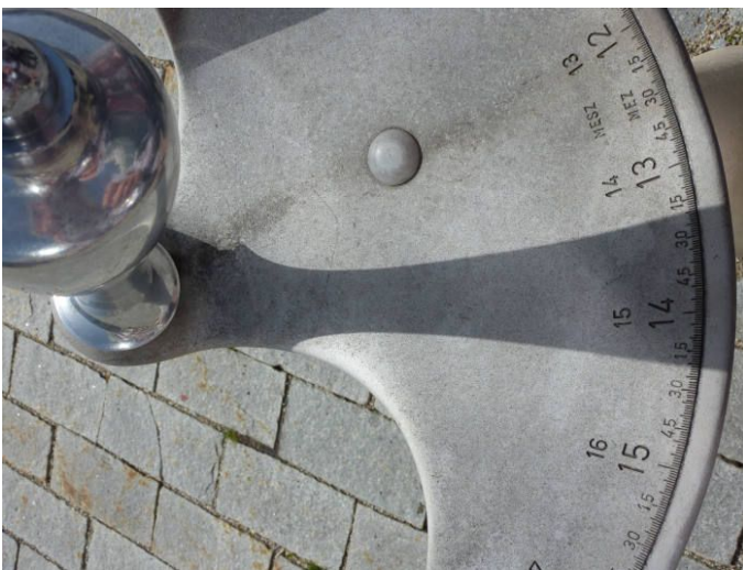
à droite : Munich photo prise le 16 avril à 11 h 29 min à gauche : Furtwangen photo prise le 11 avril à 15 h 20 min. On constate un écart de 4 minutes, en fait le style du cadran de Furtwangen n'a pas été changé au solstice d'hiver.
